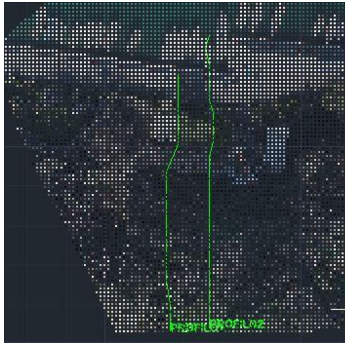
FIG.5: TRACCE DI PROFILI PASSANTI PER L'AREA INTERESSATA DALLA FRANA SU NUVOLA DI PUNTI
